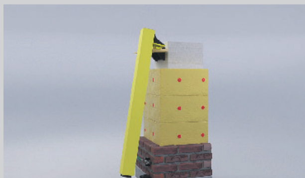
▲ Stap 3. Door de gele vergrendeling een kwartslag te draaien kan het profiel van de piramidevoet worden getild, zodat de isolatie vrij kan worden geplaatst of even opzij worden gehouden, zodat de metselaar vrij door kan pointeren achter het profiel.
